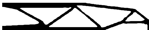
شکل (۱۴-الف) - شکل بهینه روش بهینه‌سازی توپولوژی: روش بهینه‌سازی توپولوژی تنظیم سطح
