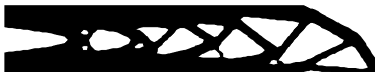
شکل (۱۴-ب) - شکل بهینه روش بهینه‌سازی توپولوژی مبتنی بر قابلیت اطمینان: روش بهینه‌سازی توپولوژی تنظیم سطح
