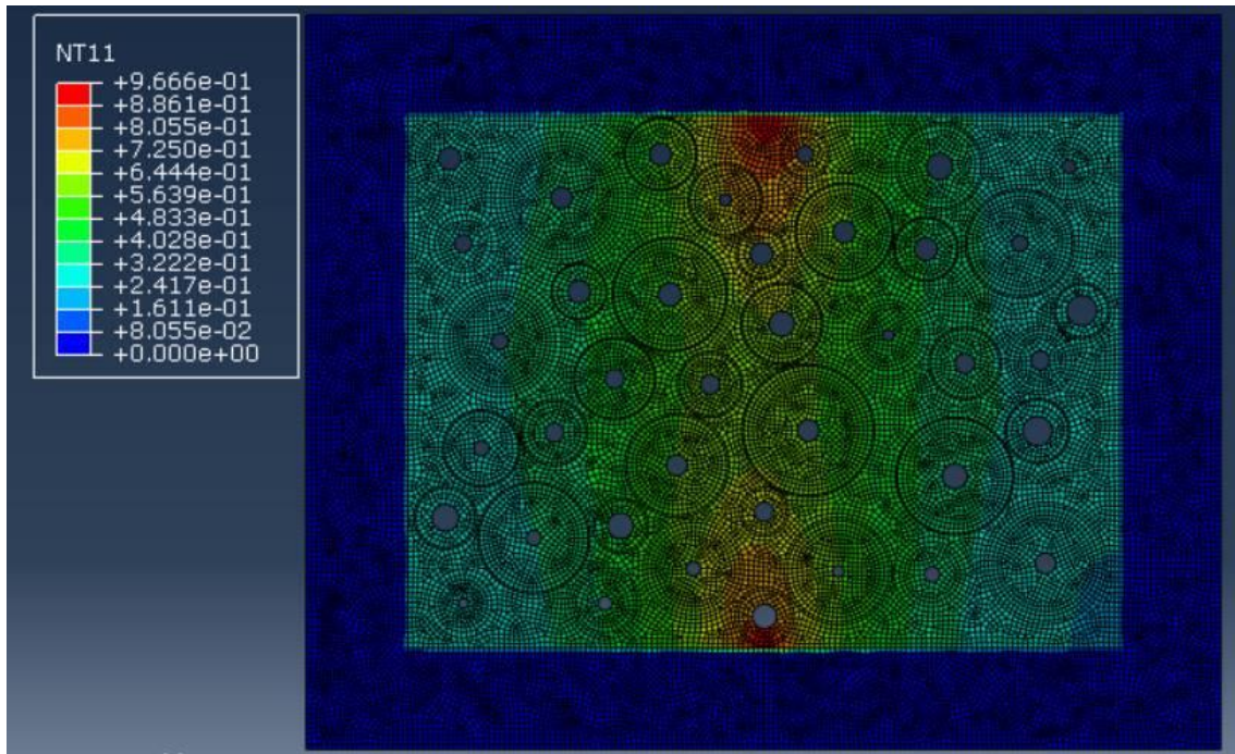
شکل ۷- توزیع پارامتر میدان فاز در ابتدای بارگذاری در زمان ۰.۰۰۶ ثانیه
