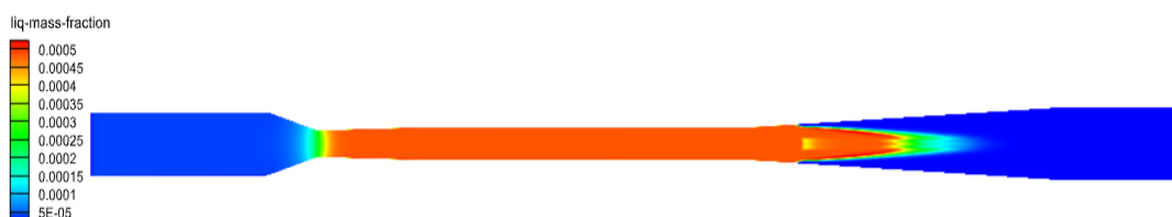
شکل ۱۰. کانتور کسر جرمی مایع در خط مرکزی نازل برای مدل دوفازی (مخلوط)
