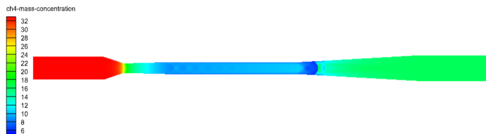
شکل ۱۱. کانتور غلظت جرمی متان در خط مرکزی نازل برای مدل دوفازی (مخلوط)
