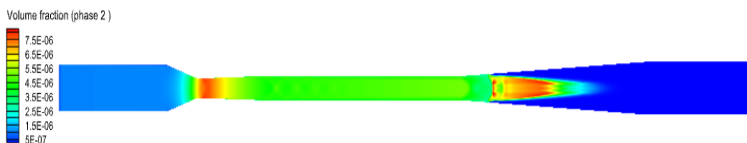
شکل ۱۲. کانتور کسر حجمی قطرات آب در خط مرکزی نازل برای مدل دوفازی (مخلوط)
