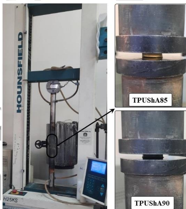
شکل ۳. دستگاه آزمایش فشار تک محوره و تصویر نمونه‌های قرار داده شده بین دو فک
