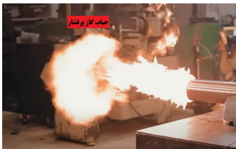
شکل ۲۸. نمایی واقعی از حباب گاز پرفشار در استارت اولیه موتور [۱۶]
