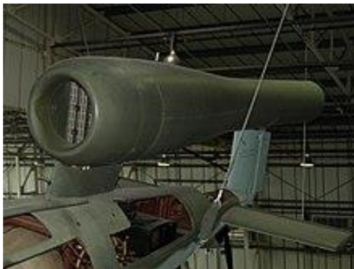
شکل ۳. موتور پالس جت آرگیوس ای اس ۱۴۰ نصب‌شده روی بمبافکن وی یک [۶]
