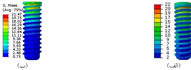
شکل ۹. راستی آزمایشی مدل‌سازی انجام شده (الف): توزیع تنش میز روی پیچ ایمپلنت اولدیری (۱۳) و (ب): توزیع تنش میز روی پیچ ایمپلنت مورد استفاده در این پژوهش
