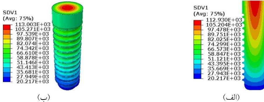
شکل ۶. توزیع مدول یانگ پیچ ایمپلنت با ساختار مدرج تابعی دوجته (الف): نمای برش خورده‌ی پیچ ایمپلنت و (ب): نمای سه‌بعدی پیچ ایمپلنت
