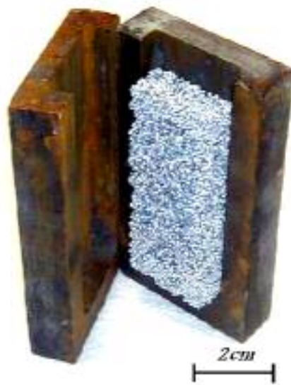
شکل ۱۱- نمایی از قالب فلزی و نحوه قرارگیری مدل فومی آغشته در داخل قالب.
