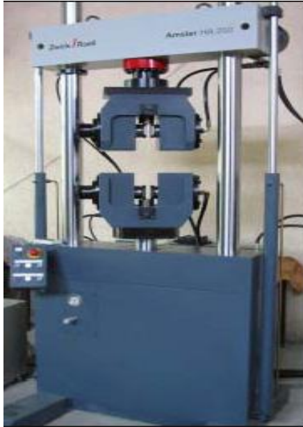
شکل ۲- دستگاه آزمون خستگی مورد استفاده برای ایجاد ترک در تیر
