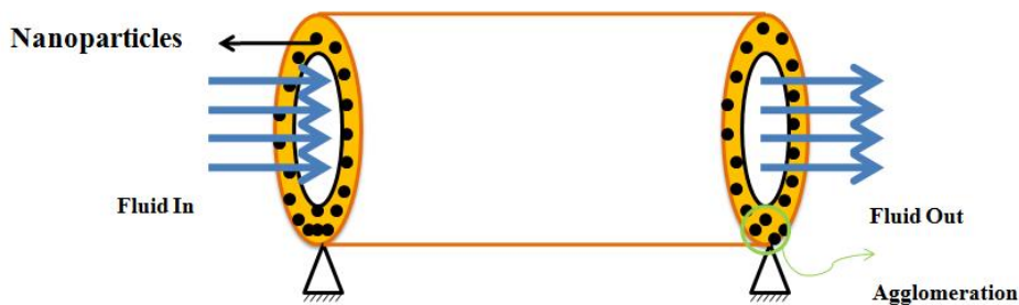
شکل ۱- شماتیک لوله حاوی جریان سیال تقویت شده با نانوذرات
